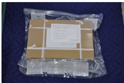
⑤資料を板ダンで挟み込み仮保管されたガスバリア袋（2020年）
